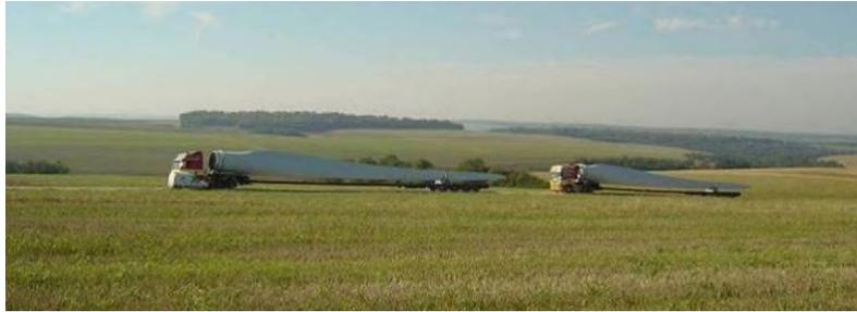
Figure 26 : Exemple de transport de pale par camion
